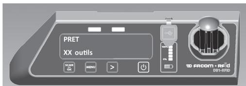
⇒ A chaque ouverture/fermeture suivi d'un déplacement du sac, un scan automatique est lancé. Ne pas ouvrir le sac pendant un scan : dans ce cas, celui-ci s'arrêtera immédiatement.
