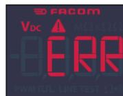
Si usted utiliza el DX.V12 en un circuito superior a 49 V, se visualiza un mensaje de error "ERR" con una alarma.
