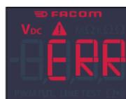
Se o DX.V12 for utilizado num circuito com mais de 49 V, é apresentado um erro “ERR” juntamente com um alarme.
