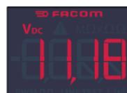
Hvis der konstateres en fejl, lyser LCD-displayet rødt, og et advarselssignal aktiveres.
