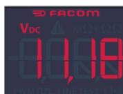
In geval van een storing, wordt de waarde in rood weergegeven met een alarm.
