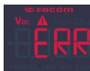
Als u de DX.V12 op een kring van meer dan 49 V gebruikt, wordt er een foutmelding “ERR” met een alarm weergegeven.
