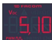
Niektóre elementy wykonawcze w samochodach są sterowane sygnałami PWM (o modulowanej szerokości impulsu). Większość turbospreżarek, zaworów sterujących prędkością obrotową biegu jałowego, zawór EGR itp. jest sterowanych sygnałami PWM.
