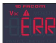
Benutzen Sie das DX.V12 bei einem Stromkreis mit über 49 V, erscheint die Fehlermeldung „ERR“ und ein Alarm ertönt.
