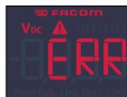
W przypadku podłączenia testera DX.V12 do obwodu z napięciem wyższym niż 49 V, na wyświetlaczu pojawia się wskazanie «ERR» i emitowany jest alarm.
