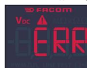
Je-li přístroj DX.V12 použit v obvodu s napětím překračujícím 49 V, zobrazí se chybový údaj «ERR» s výstrahou.
