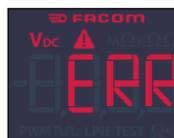
Si vous utilisez le DX.V12 sur un circuit supérieur à 49 V, un message d'erreur «ERR» s'affiche avec une alarme.
