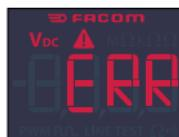
Hvis DX.V12 bruges i et kredsløb med mere end 49 V, vises fejlen «ERR» med et advarselssignal.
