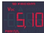
Alguns atuadores de automóveis são acionados por sinais PWM (Power Wide Modulation). A maioria das descargas de TURBO, válvulas de ralenti, EGR... são acionadas por sinais PWM.
