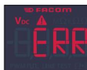
Se il DX.V12 viene usato su un circuito superiore a 49V un messaggio «ERR» viene mostrato con un allarme.
