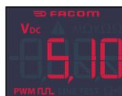
Bestimmte Stellglieder werden über PWM-Signale (Pulse Width Modulation) gesteuert. Die meisten TURBO-Auslässe, Minderdruckventile und EGR werden über PWM-Signale gesteuert.
