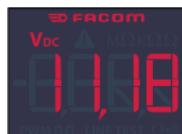
W przypadku wykrycia usterki, wyświetlacz LCD zmienia kolor na czerwony i emitowany jest alarm.
