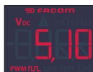
Sommige aandrijvers worden gestuurd door PWM-signalen (Pulse Width Modulation). De meeste TURBO uitlaten, smoorklepopeningen en EGR-kleppen worden gestuurd door PWM-signalen.
