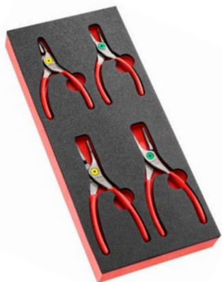
MODULE 4 PINCES POUR CIRCLIPS® MODM.PCSN - 177A.13 (10 - 25 mm) - 177A.18 (19 - 60 mm) pinces bec droit extérieurs - 179A.13 (12 - 25 mm) - 179A.18 (19 - 60 mm) pinces bec droit intérieurs - Plateau mousse : PM.MODPCSN Poids: 0,70 kg
