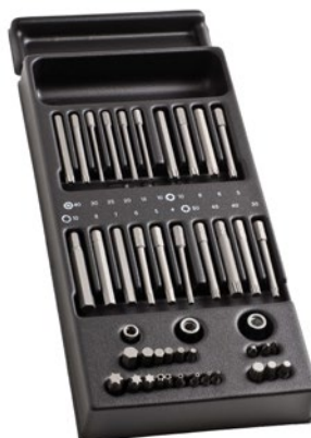
MODULE 41 EMBOUTS LONGS ET COURTS ET 3 DOUILLES PORTE-EMBOUTS MOD.E41 6-Pans : EH.2L : 4 - 5 - 6 - 7 - 8 - 10 mm EH : 4 - 5 - 6 - 7 / EH.2 : 8 - 10 mm XZN : EV.2L : 5 - 6 - 8 - 10 mm / EV : 6 - 8 - 10 mm Torx® : EX.2L : 30 - 40 - 45 - 50 / EX.2 : 45 - 50 - 55 Resistorx® : EXR.1L : 10 - 15 - 20 - 25 - 30 - 40 EXR.1 : 10 - 15 - 20 - 25 - 30 - 40 Pozidriv embouts : 1 - 2 - 3 - S.J.236 : douille porte embouts 5/16" - R.235 : douille 1/4" porte embouts - S.236 : douille 1/2" porte embouts 5/16" - Plateau thermoformé : PL.621 Poids : 0,895 kg
