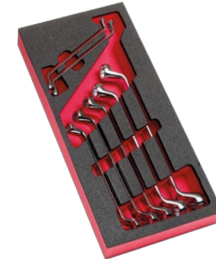
MODULE 7 CLÉS POLYGONALES CONTRE COUDEES OGV® DE 6 À 19 MM MODM.55A-1 - 55A. : 6 x 7 - 8 x 9 - 10 x 11 - 12 x 13 14 x 15 - 16 x 17 - 18 x 19 mm - Plateau mousse : PM.MOD55A-1 Poids : 0,92 kg
