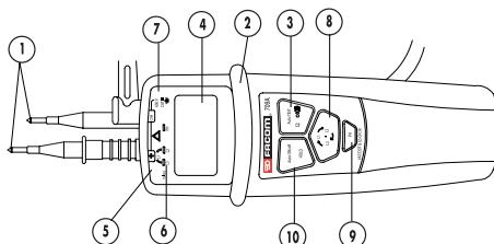
**1. Abnehmbare Prüfspitze:** • 2mm
