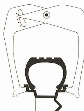
In geval de gewichten verborgen in de velg moeten worden geplaatst (balanceerprogramma 4 en 5), meet met de meetlat UA.REG in inches de afstand tussen de vlakken waarin het plaklood aangebracht zal worden en stel de knop (2) in op deze waarde.
